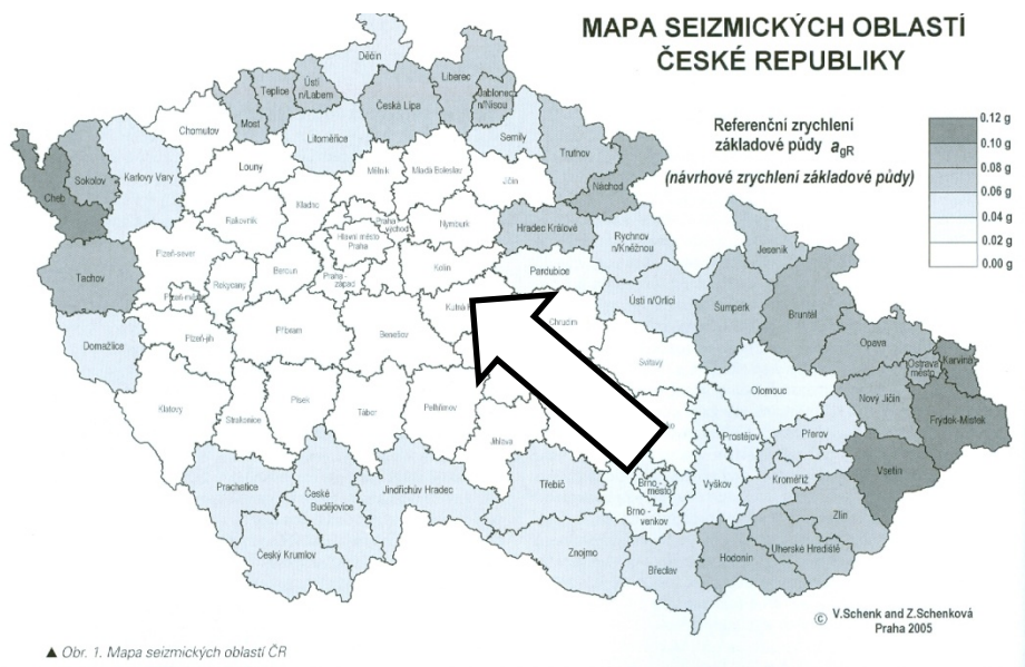
▲ Obr. 1. Mapa seismických oblastí ČR
